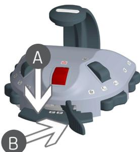
Pressionando a tecla para baixo (A) e a alavanca para direita (B) juntamente, acionará a turbina de alta rotação ar e água (spray).
