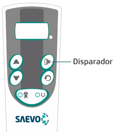
Durante la exposición, un LED amarillo visible y una señal sonora continua indicarán la presencia de rayos-X. Después del término de la exposición de rayos-x, la señal sonora es interrumpida y se puede soltar el disparador. El equipo entrará en modo de enfriamiento y el mensaje **"SBY"** aparece en la pantalla intercalada con el tiempo de exposición previamente seleccionado.
