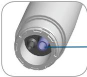
Canal para Lubricación (Entrada de aire)
